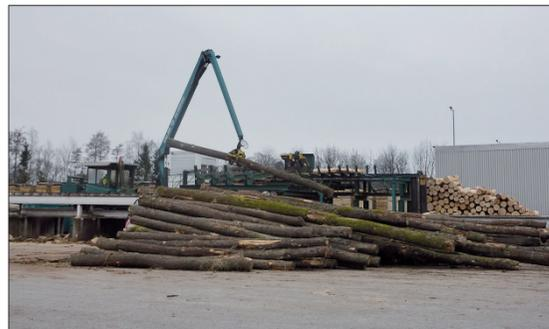
Auf dem Rundholzplatz von Wagener wird das Laubholz mittels Einteilwagen und Entindung vorbereitet.
