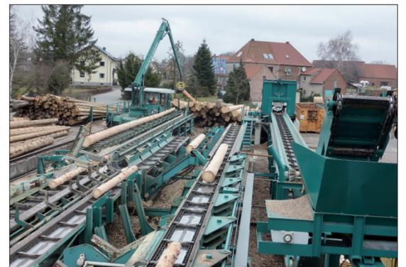
Rundholzplatz bei Alpmann mit geeichter Werkseingangsvermessung und einer Entindungsanlage.
