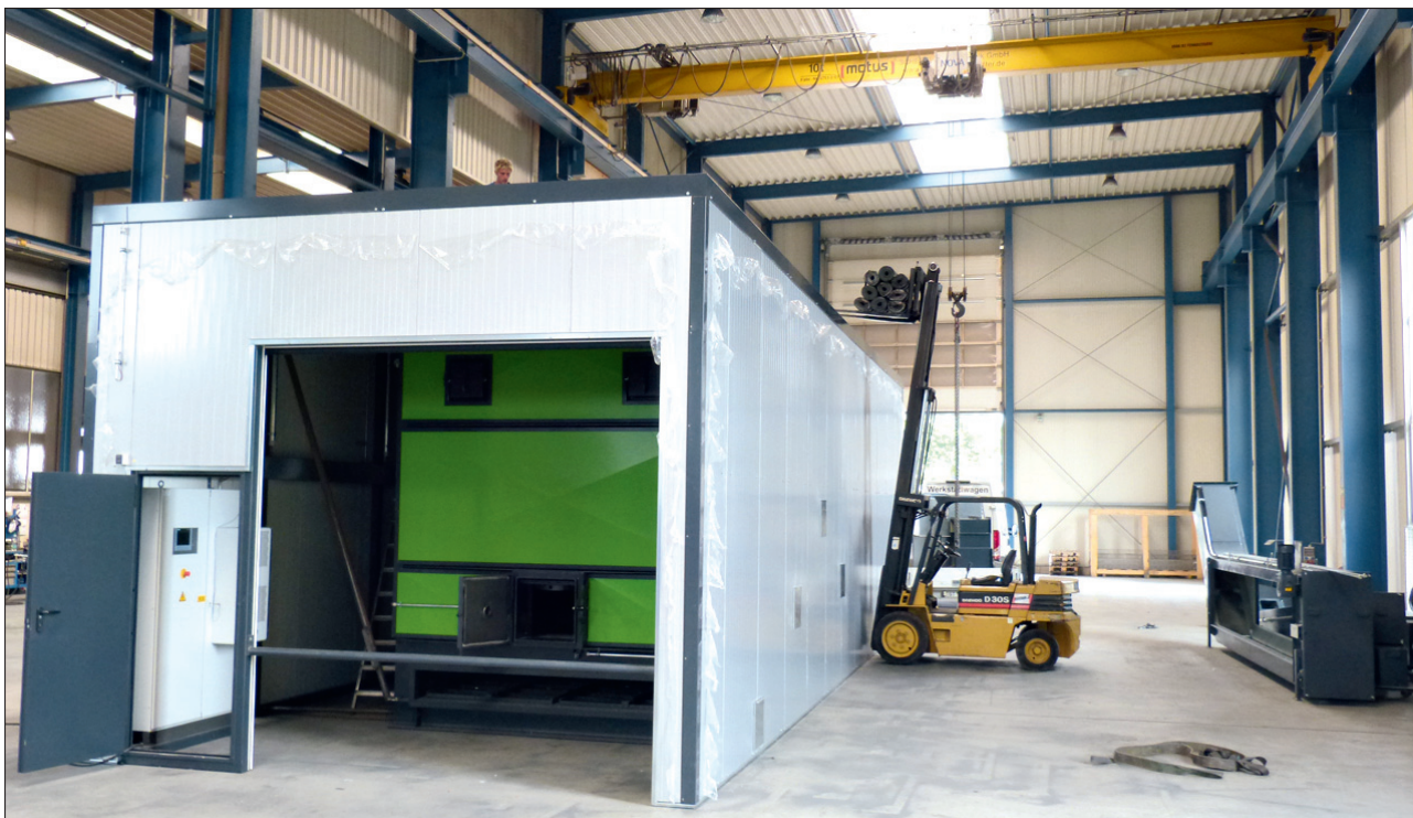
Erstmals hat Polzenith einen 3 MW-Kessel in einem einzigen Container untergebracht.
