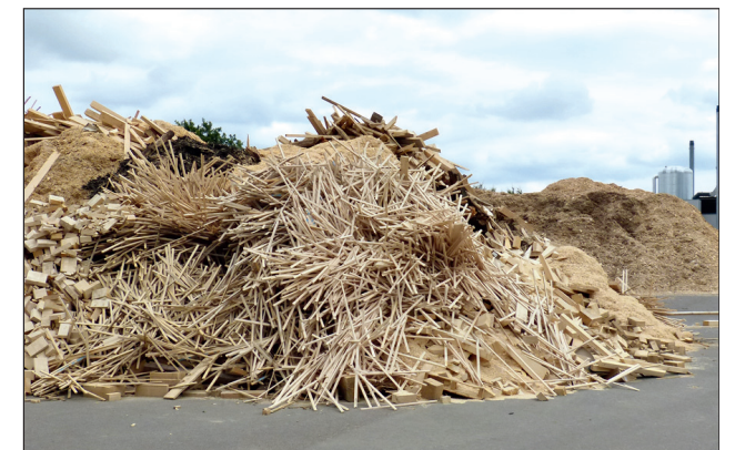
Während die stückigen Reste noch gehackt werden müssen, gehen die Späne von den Wurzelreduzieren (Hintergrund) direkt in den Bunker. Dort erfolgt auch die Mischung.
